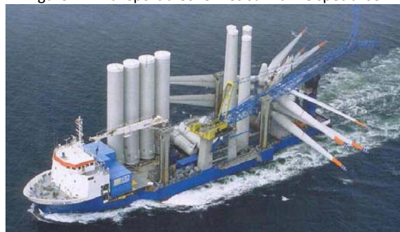
Figure 17. Transport d'éoliennes sur navire spécialisé.
